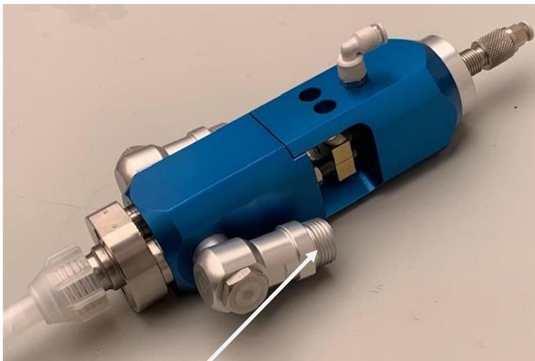
Válvulas anti-retorno fornecidas à parte, conexão ½" BSP
