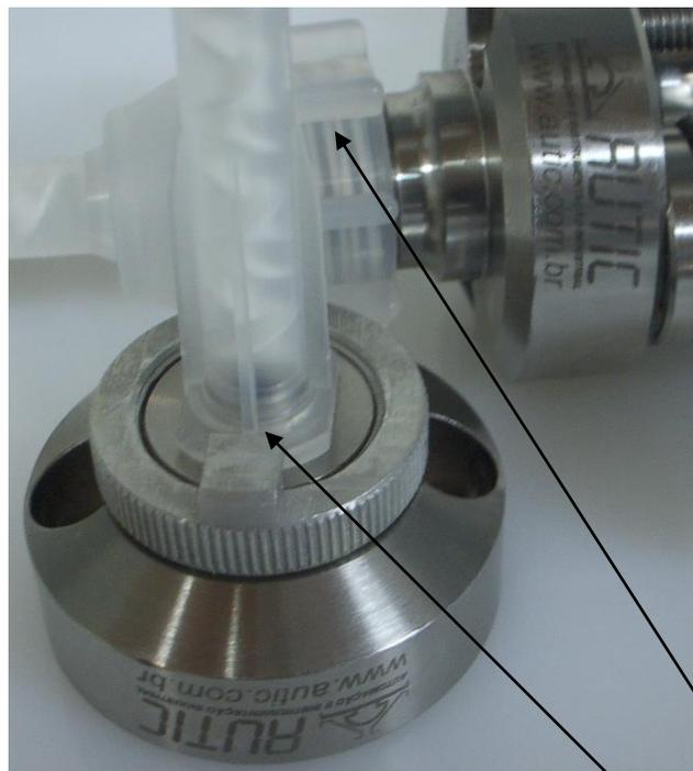
Dois modelos de bico podem ser usados encaixe baioneta, ou cone rosca.
